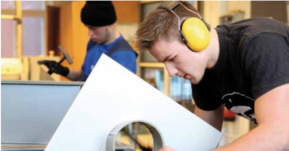
Finlir. Felix Arsell justerar rörstosen. Materialet är 0,6 mm lackerad stålplåt, vilket är en tunnare plåt än vad eleverna är vana att jobba med.
