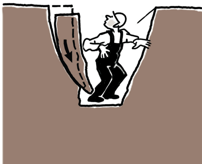
Även ett skred med liten utbredning kan bli farligt om schakten är smal. Illustration: Ingela Jondell
